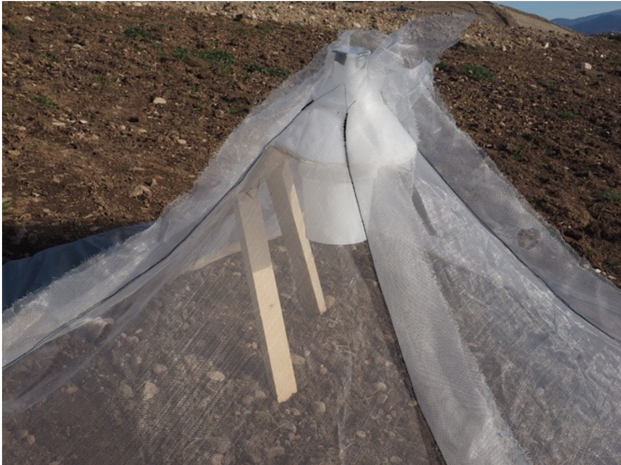
Abbildung 6: Aufbau Netz, Trichter und Tötungsbehälter. Die Dachlatte, die das Netz aufspannte, wurde am Trichter befestigt. Foto: Anne-Christine Mupepele.
