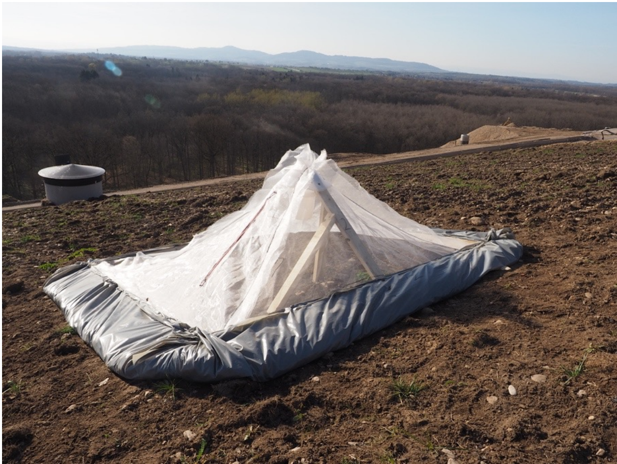
Abbildung 4: Aufbau einer Emergenzfalle. Das Grundgerüst ist ein rechteckiges Dachlattengerüst. Eine Dachlatte, die im Boden befestigt wurde, spannt das Netz über dem Grundgerüst auf. Zur Festigung wurden Stützbalken eingebaut. Die Falle wird durch eine Plane, die mit Kies und Sand befüllt ist, befestigt. Die Plane gleicht Unebenheiten zwischen dem Boden und dem Grundgerüst aus, sodass keine Tiere austreten können. Foto: Anne-Christine Mupepele.
