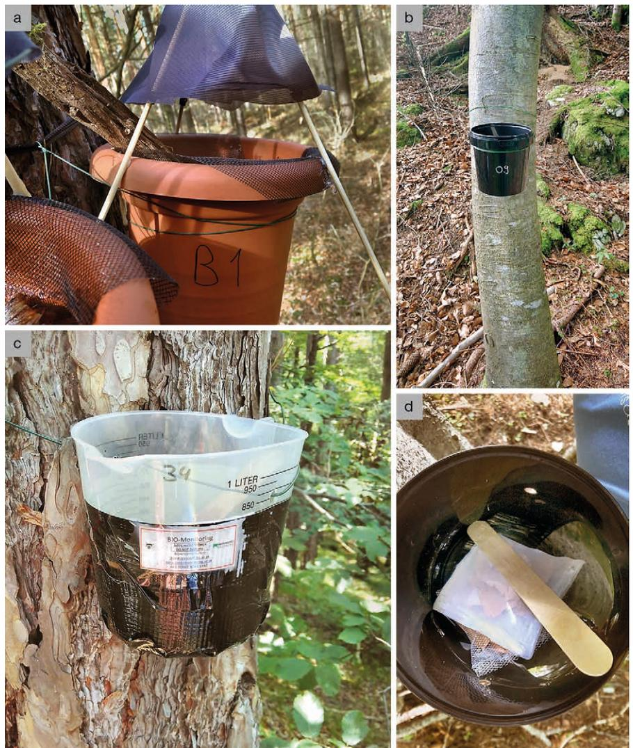
Abb. 6: Beispiele für künstliche wassergefüllte Baumhöhlungen (Dendrotelme) aus wissenschaftlichen Experimenten und Studien (z. B. Petermann et al. 2016). a) Wassertopf mit Netzschutz aus den Biodiversitäts-Exploratorien. b) ConnectPLUS Studie in Österreich zur Konnektivität von Naturwaldflächen. c) und d): Beispiel aus dem Wienerwald im Rahmen des globalen MICROCosm Experiments. (Fotos: a) Anastasia Roberts, b), d) Lena Holzapfel, c) David Zezula)
